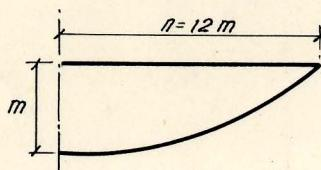
La tracción en cada cable en la sección central es de 11.000 kg. y como el diagrama del momento es parabólico, el incremento de tracción
