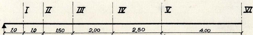
fuerzas tangenciales y momentos flectores, ambos para peso muerto y sobrecarga separadamente, en cada una de las secciones, y después las tensiones unitarias para distintas fibras de la sección, con lo que se tienen los datos para el trazado de los círculos de Mohr.
