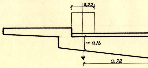
La Instrucción Oficial para el Proyecto y Ejecución de Obras de Hormigón admite que, cuando no se estudia el reparto elástico de las cargas concentradas, se pueden considerar éstas repartidas en una longitud igual a los  $\frac{4}{3}$  de su distancia al apoyo; por otra parte, la longitud de reparto de la carga en el eje de aplicación de la fuerza, según la antedicha Instrucción, es
