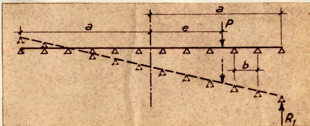
Soit, à cette hypothèse  $R_1$ , la réaction sur la poutrelle extrême. Par l'action du moment de torsion  $P_e$ , la valeur de cette réaction  $R_1$ , est:
